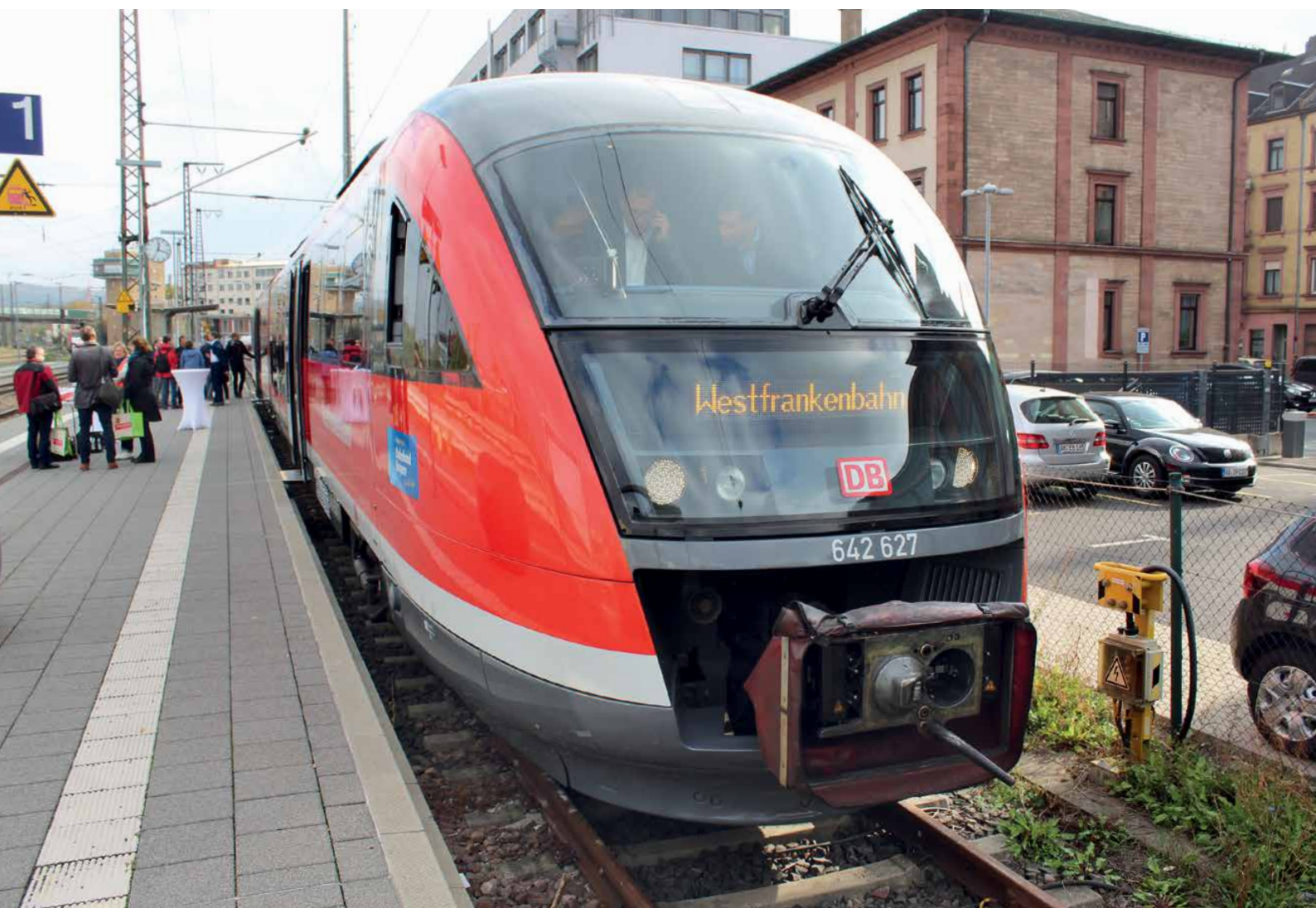
Die Desiro für die Westfrankenbahn erhalten unter anderem besser lesbare LED-Matrix-Anzeigen sowie ausfahrbare Schiebetritte.
